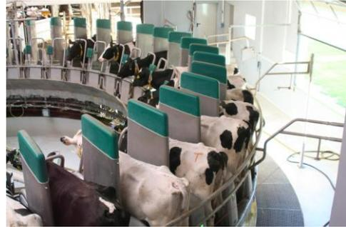
Diese „Vorgaben“ wurden umgesetzt in der Einzelmodullösung, pro Melkplatz steht ein vollständig unabhängiges Modul bereit, das für „sich allein melkt“. Im Prinzip stehen bei der GEA Lösung je nach Größe 28-80 kleine Einzelroboter auf der Plattform zum Melken zur Verfügung.
