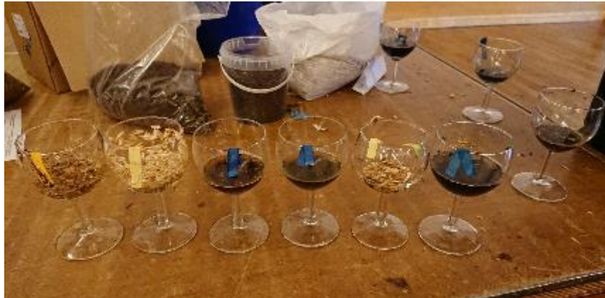
pH-Wert Überprüfung bei verschiedenen Kompostproben und Einstreumaterial v.li: Sägespäne, Dinkelspelzen, Kompost, Kompost, Hackschnitzel, Kompost)
