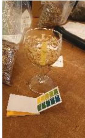
pH- Wert Überprüfung mit Indikatorpapier
