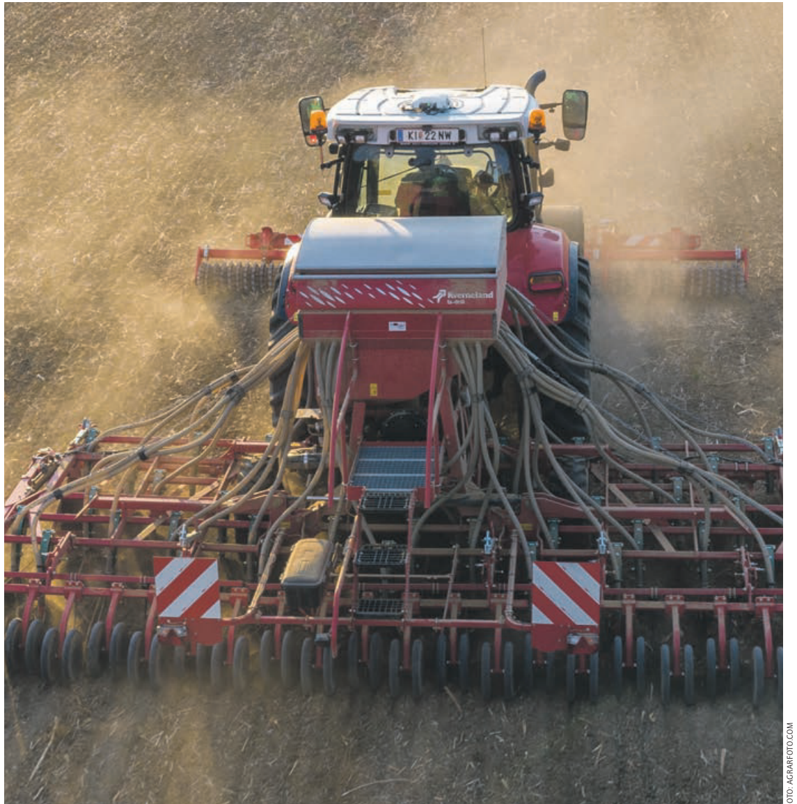
Gegenüber konventioneller Bodenbearbeitung mit Pflug können bei der Mulchsaat rund 50 Prozent Kraftstoff eingespart werden, im Fall einer Direktsaat sind sogar bis zu 90 Prozent möglich.
