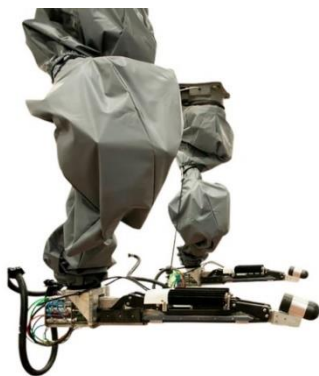
Diese Roboterarme von Green Source Automation sind für den Einsatz in einem Melkkarussell konzipiert. Hersteller: Green Source Automation.
